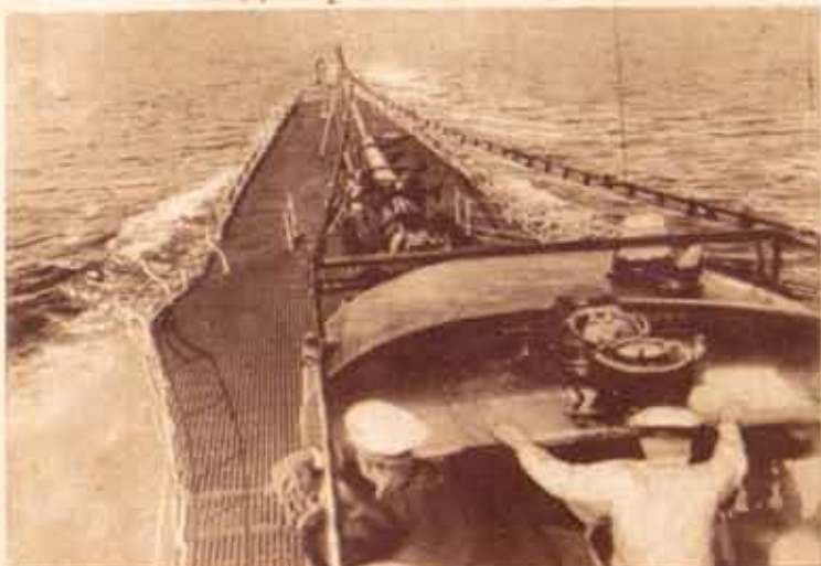
Америчка морнарица објавила је своју флоту једним новим типом подморница. То је оклопна подморска крстарица са брзином од 17 чворова (15000 миља). Посада износи 7 официра и 61 човек. Може да плува 60 дана без повременог снабдевања
