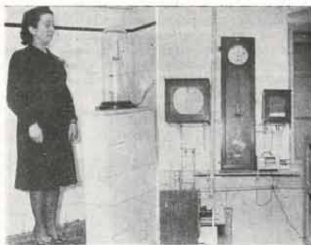
Сл. 9: Сеизмоскоп Агамеионове конструкције за објављивање великих потреса (лево); сл. 10: Првобитна Рифлерова пандила као нормални часовник (десно).
