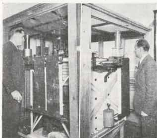
Сл. 18: Нормални Вихертов сеизмограф за хоризонталне покрете тла — маса 1000 кг. (лево); сл. 19: Нормални Вихертов сеизмограф за вертикалну компоненту покрета тла — маса 1300 кг. (десно).
