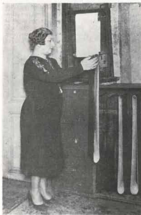
Сл. 11. — Апарат за гарављење и фиксирање сеизмографских места на којима се уписују земљотреси.
